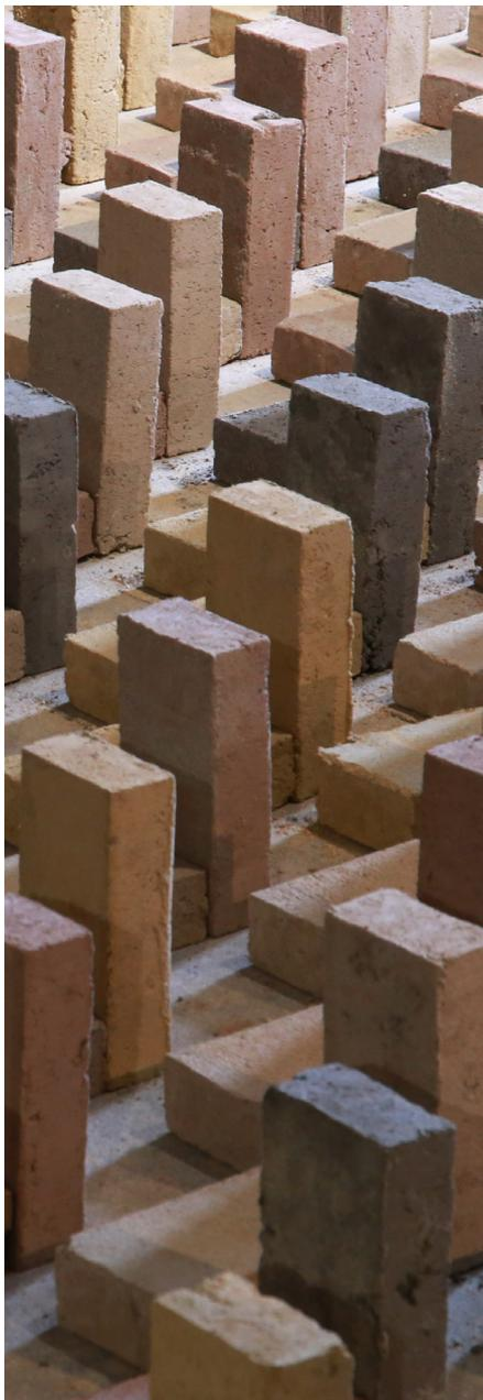
*Le Projet Cycle Terre* envisage à partir de l'été 2019 une **pré-production de briques en semi-artisanal**, réalisée par un fabricant existant, permettant de répondre à des commandes à court termes tout en produisant des prototypes pour les tests sur les matériaux. La fabrique Cycle Terre, produisant des BTC, des BTE, des panneaux extrudés, des mortiers et des enduits, ouvrira à l'automne 2020. De la terre préparée pourrait aussi être directement vendue, par exemple pour du pisé.
